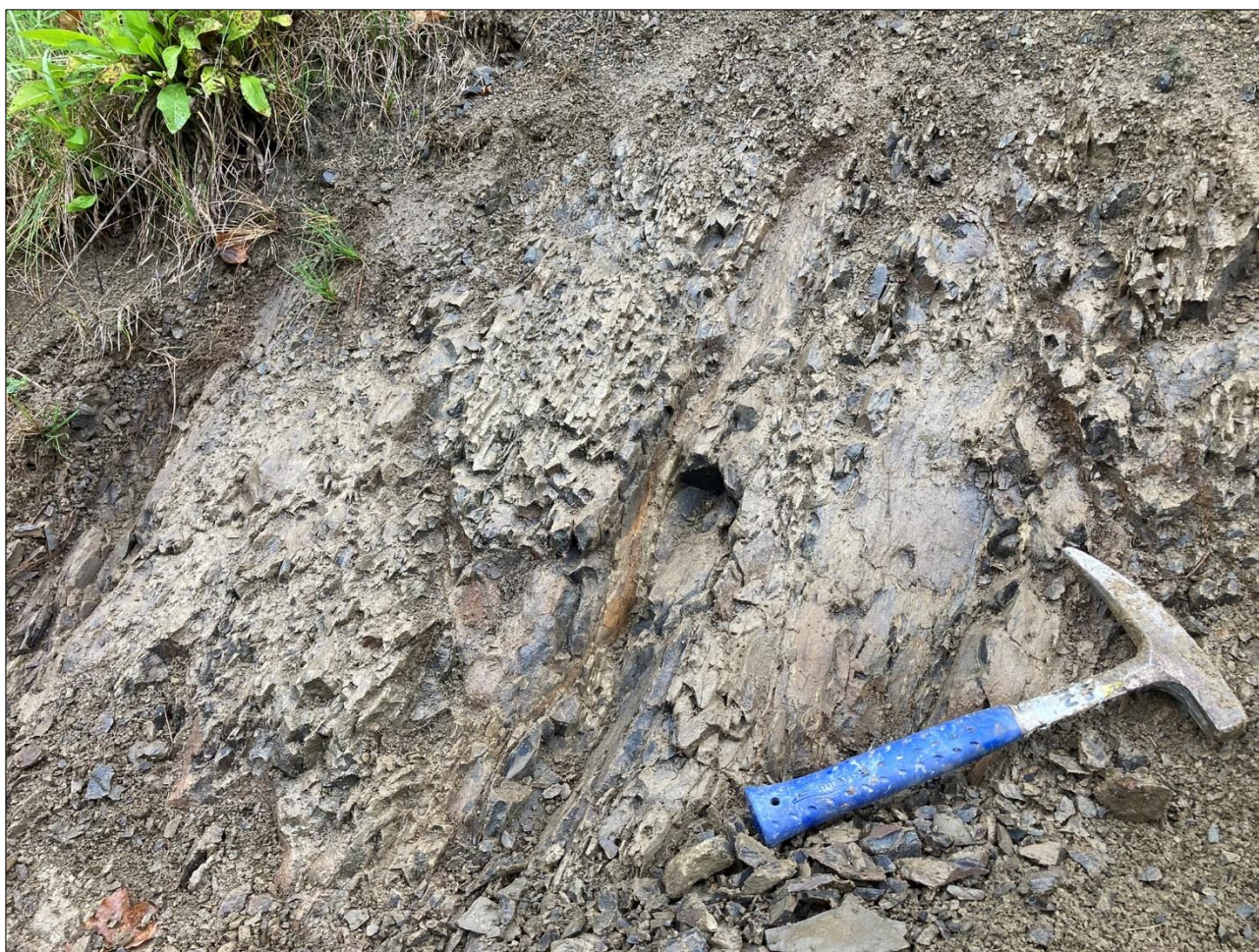
Obrázek 1 Ojedinělý výchoz strmě uložených jílovců se střípkovitým rozpadem (u domu č.p. 565)
